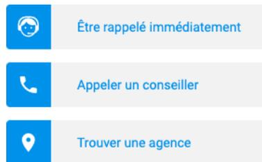
Figure 65 - Taux de contraste (1,1:1) insuffisant entre la couleur (#f1f1f1) et l'arrière plan contigüe (#fff) (Accueil - connecté)
