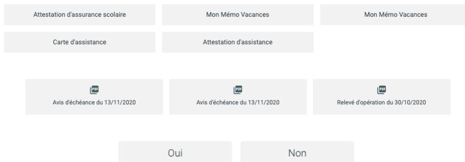
Figure 67 - Taux de contraste (1,1:1) insuffisant entre la couleur (#f1f1f1) et l'arrière plan contigüe (#feffff)
